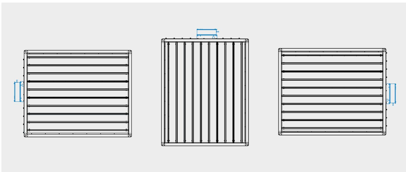
Il collegamento della serranda alle condotte per estrazione fumi per comparto singolo avviene per mezzo di un profilo a flangia da 30 mm, viti e bulloni. La distanza di installazione della serranda da altri elementi edili, ostruzioni e componenti di impianto deve essere tale da permettere il montaggio, il funzionamento e la manutenzione della serranda stessa.
