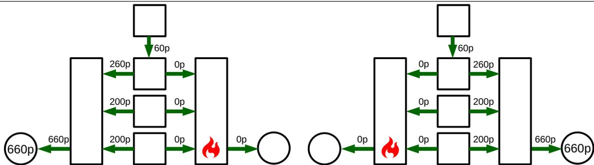
Si esegue la verifica di ridondanza (§ S.4.8.6), individuando le condizioni più gravose per i componenti del sistema d'esodo. Nelle figure soprastanti sono riportati solo gli esiti più gravosi.
