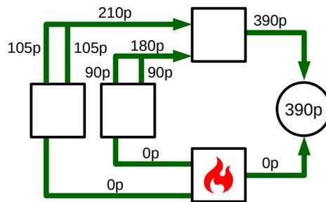
Si esegue la verifica di ridondanza (§ S.4.8.6), individuando le condizioni più gravose per i componenti del sistema d'esodo. Nelle figure soprastanti sono riportati solo gli esiti più gravosi.
