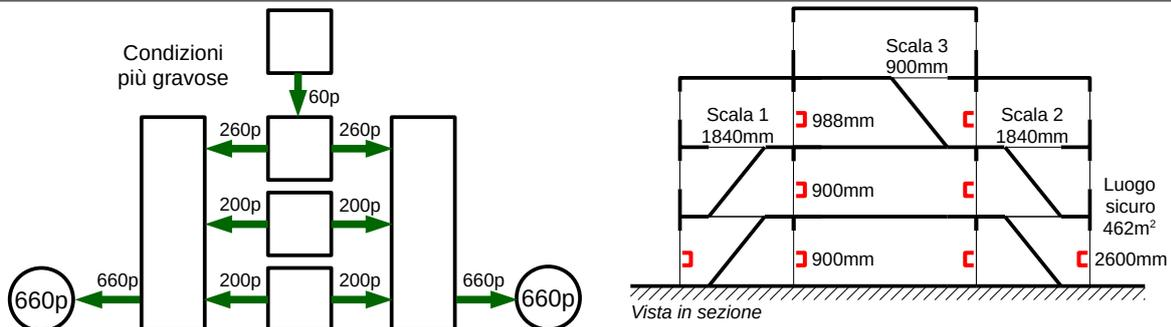
Impiegando le condizioni più gravose, si calcolano le larghezze minime (§ S.4.8.5), ad esempio:
