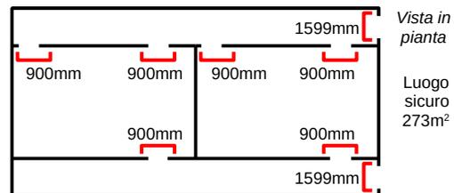
Impiegando le condizioni più gravose, si calcolano le larghezze minime (§ S.4.8.5), ad esempio:
