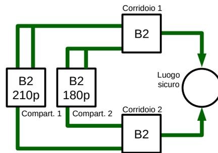
Dalla geometria dell'attività si elabora lo *schema* delle vie d'esodo e si definiscono i dati di ingresso (§ S.4.6): profilo di rischio  $R_{vita}$  di riferimento ed affollamento. Nel caso specifico si ritiene trascurabile l'affollamento nei corridoi di transito. Tenendo conto dei requisiti antincendio minimi (§ S.4.7), dopo aver definito il numero minimo di vie d'esodo ed uscite (§ S.4.8.1), si verificano eventuali corridoi ciechi (§ S.4.8.2) e le lunghezze d'esodo (§ S.4.8.3).
