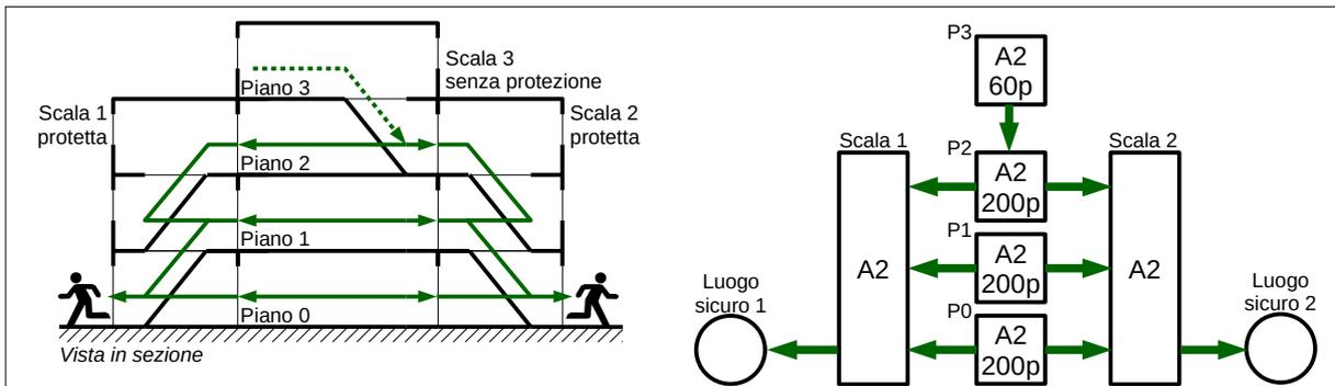
Dalla geometria dell'attività si elabora lo *schema* delle vie d'esodo e si definiscono i dati di ingresso (§ S.4.6): profilo di rischio  $R_{vita}$  di riferimento ed affollamento. Tenendo conto dei requisiti antincendio minimi (§ S.4.7), dopo aver definito il numero minimo di vie d'esodo ed uscite (§ S.4.8.1), si verificano eventuali corridoi ciechi (§ S.4.8.2) e le lunghezze d'esodo (§ S.4.8.3).
