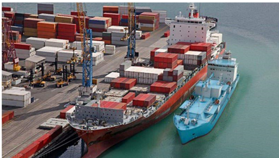
Fig. 4.2: Bunkeraggio STS (tratto da Linee Guida EMSA)
