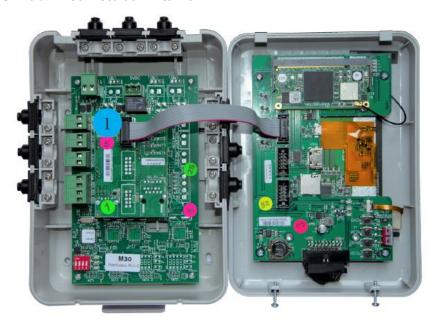
Appena il SEDuct<sup>®</sup> M30 viene collegato all'alimentazione, si avvia automaticamente il dispositivo di controllo e la comunicazione con i moduli di campo SEDuct<sup>®</sup> UFC.
