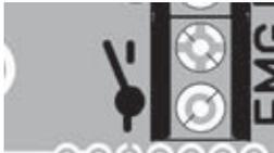
**linea 3** stesse caratteristiche della LINEA2 ma non resettabile interrompendo momentaneamente l'alimentazione. Normalmente si collega a tale ingresso il pulsante emergenza o il loro parallelo.
