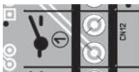
**Linea 1** si collega normalmente il contatto pulito proveniente da sistema di rilevamento incendio centralizzato.
