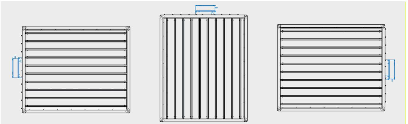
**!** Nell'installazione della serranda SEDuct<sup>®</sup> SDS su condotte orizzontali è consentito il posizionamento dell'attuatore solo lateralmente o superiormente.
