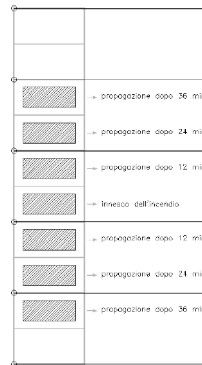
Configurazione Scenari d'incendio RTV V6 - Autorimessa
