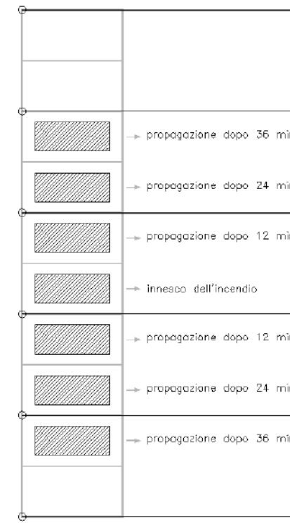
Configurazione Scenari d'incendio RTV V6 - Autorimessa
