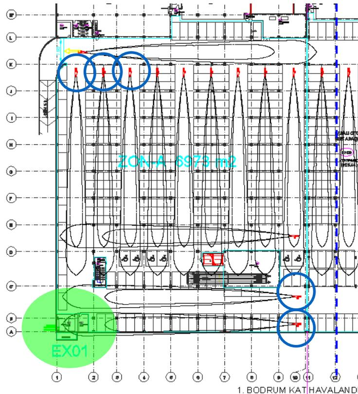
qui 5 ventilatori Jet Fan movimentano l'aria direttamente verso l'estrazione.
