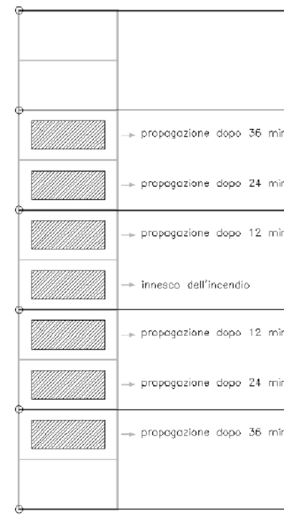
Configurazione Scenari d'incendio RTV V6 - Autorimessa
