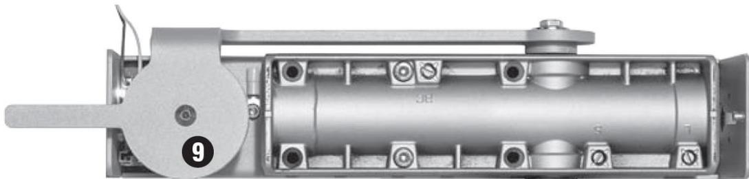
Dare alimentazione al magnete ed armarlo manualmente portando la contropiastra (9) a contatto dell'elettromagnete.
