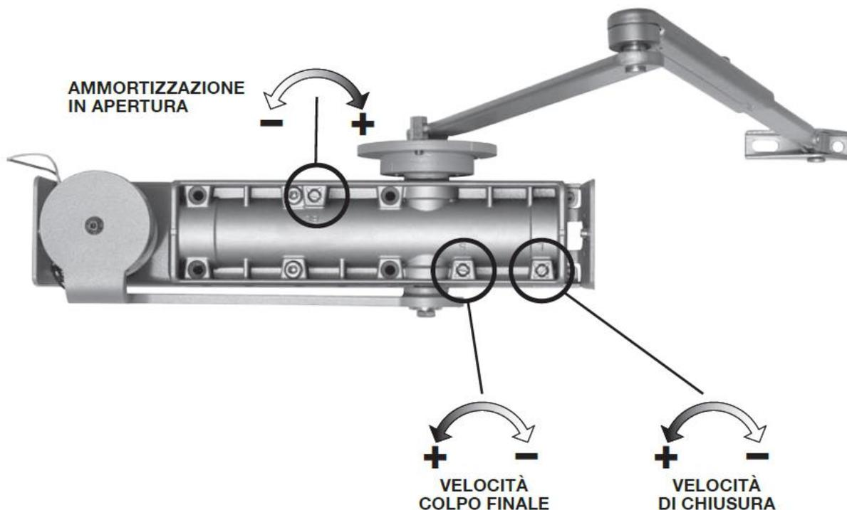
Effettuare un ciclo di apertura della porta premendo il tasto SBLOCCO (17). Effettuare la regolazione della velocità di apertura agendo sulle apposite viti. Ripetere il ciclo apertura/chiusura della porta fino ad ottenere la velocità desiderata agendo sulle viti di regolazione.
