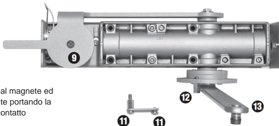
Dare alimentazione al magnete ed armarlo manualmente portando la contropiastra (9) a contatto dell'elettromagnete.
