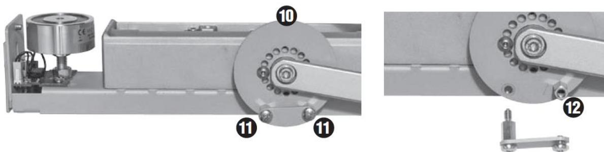
Togliere le viti di bloccaggio (11) e la relativa piastrina poste sul disco di regolazione (10). è importante NON RIMUOVERE il perno sottostante la vite di destra (12).
