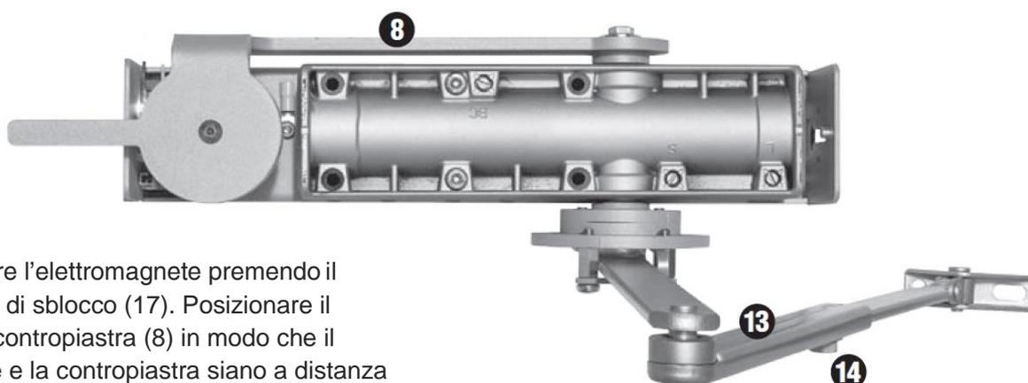
Sganciare l'elettromagnete premendo il pulsante di sblocco (17). Posizionare il braccio contropiastra (8) in modo che il magnete e la contropiastra siano a distanza di almeno 20 mm.
