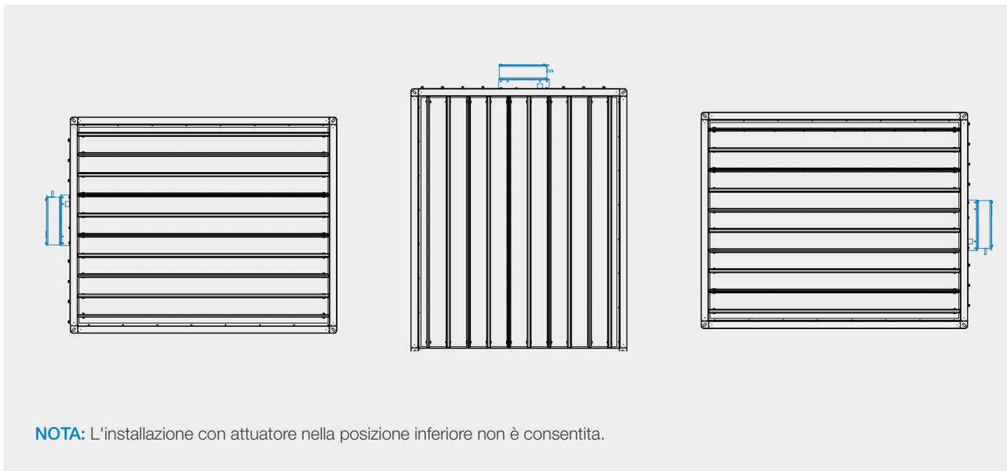
Il collegamento della serranda alle condotte per estrazione fumi per comparto singolo avviene per mezzo di un profilo a flangia da 30 mm, viti e bulloni. La distanza di installazione della serranda da altri elementi edili, ostruzioni e componenti di impianto deve essere tale da permettere il montaggio, il funzionamento e la manutenzione della serranda stessa.
